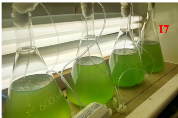
I1 e I2) Pré-Inóculo, I3) Microplaca, I4) Leitora de Microplacas, I5, I6, I7 e I8) Cultivos em Erlenmeyers de 6L em diferentes estágios.
